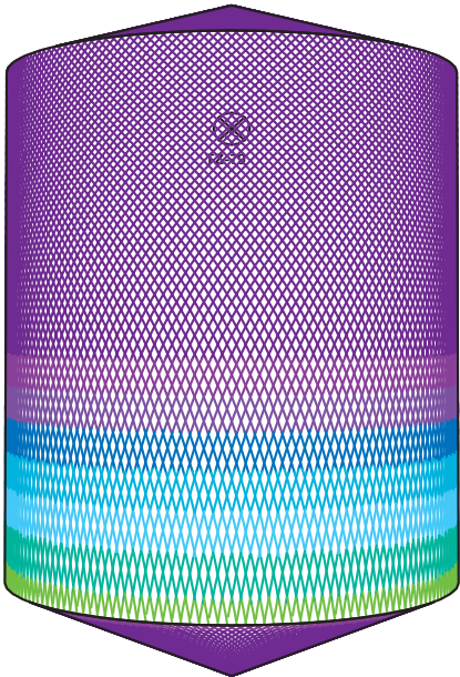
D8m H10m, Toftejorg TZ-79, 4 x ø10 mm, 0 % 时间 = 23.3 分钟, 耗水量 = 10868 升
