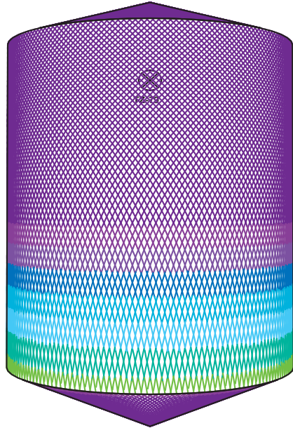
D8m H10m, Toftejorg MJ504, mm x ø10 0, 23 % 时间 = .3 分钟, 耗水量 = 10868 升
