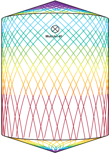
D5m H6m, Toftejorg MultiJet 40, 4 x ø6 mm, 100% 时间 = 4.3 分钟，耗水量 = 887 升
