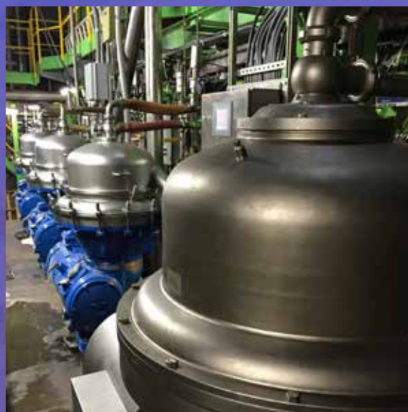
Le skimmer Alfa Laval permet à Westward Seafoods de réduire la teneur en huile de sa liqueur visqueuse à moins de 0,5 %.
