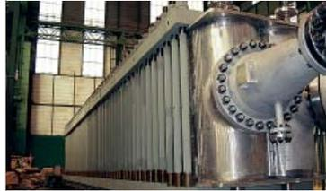
**Теплообменник Альфа Лаваль Packinox** может весить до 350 тонн, и одного такого теплообменника обычно достаточно для
