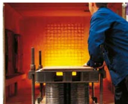
Nous utilisons une résine époxy à deux composants cuite au four pour les échangeurs ouverts fréquemment, de telle sorte que la fixation des joints reste impeccable, même après un nombre incalculable d'ouverture.
