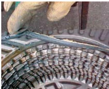
Si les joints et la colle usagés ne sont pas retirés en totalité, l'étanchéité finale sera insuffisante et le risque de fuite élevé.
