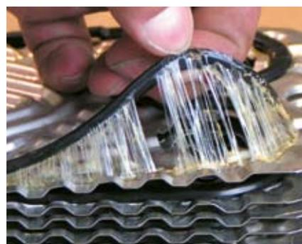
Si une colle standard est utilisée sur un échangeur ouvert fréquemment, les joints peuvent se détacher et donc nécessiter un rejointage après ouverture.
