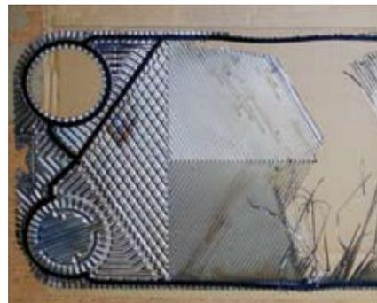
Le nettoyage chimique requiert des mesures correctes en termes de concentration, de température et de temps. Sinon, les plaques peuvent être détruites.
