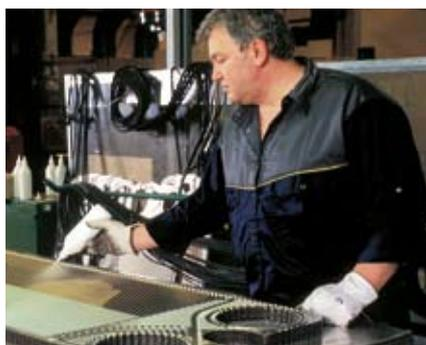
Les joints et les colles Alfa Laval sont spécifiquement élaborés pour permettre un positionnement et une adhérence parfaite du joint.
