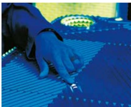
Nous recherchons les piqûres et les crevasses à l'aide de techniques avancées, notamment avec une procédure de ressuage ou une procédure par ultraviolets, afin de détecter les micro-fissures.
