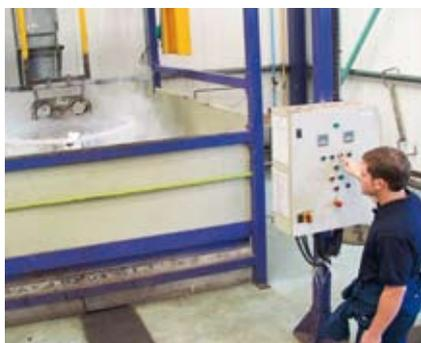
Grâce à des supports tels que l'azote liquide et la soude caustique, nous retirons les joints dans leur totalité et avec soin, afin d'avoir des gorges propres et non endommagées.
