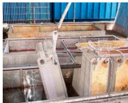
Nous recourons à un nettoyage par hydrojet unique ou à des bains chimiques spécialisés dont la concentration et la température sont minutieusement régulées pour assurer un cycle de nettoyage parfait.
