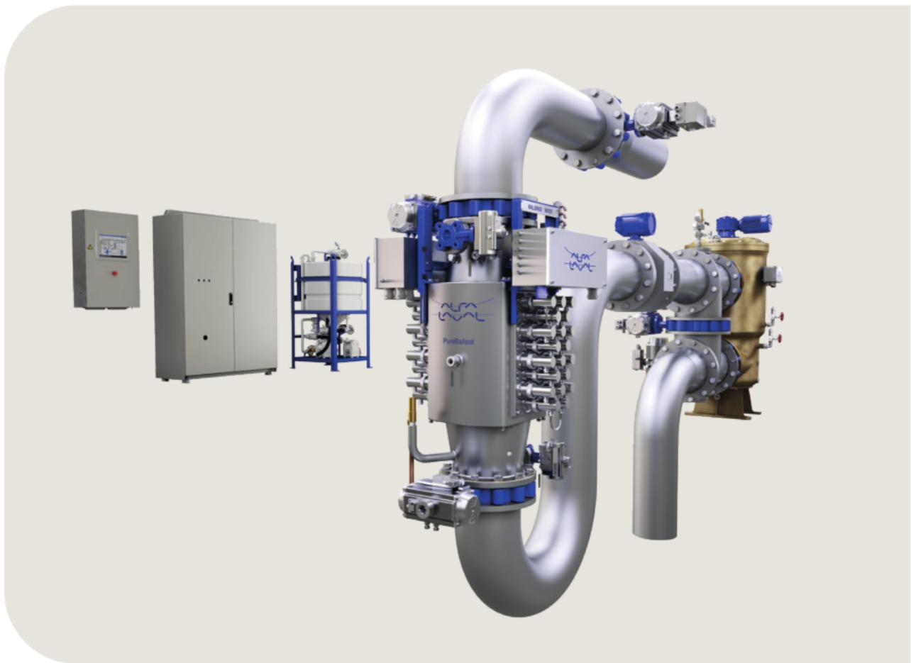
阿法拉伐自有的压载水管理解决方案，即阿法拉伐PureBallast，采用过滤和紫外线处理。对于所有紫外线系统，有两种情况可能会出现挑战性水质状况。第一种是紫外线透过率低的水，可能导致紫外线强度低于系统设计限制（SDL）。第二种是高输沙量，可能导致压差增加和滤清器堵塞。
