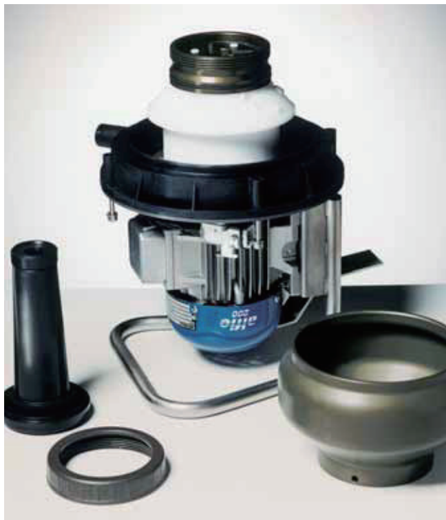
离心机由锥形离心泵送料，离心机与离心泵由同一电机驱动。
