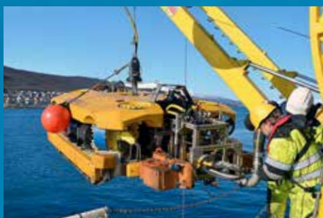
Le système de déchargement à distance des épaves Framo est prêt à entrer dans l'eau
